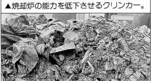
▲焼却炉の能力を低下させるクリンカー。
