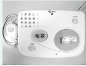
緊急通報装置
