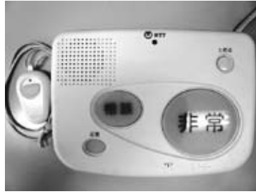
緊急通報装置
