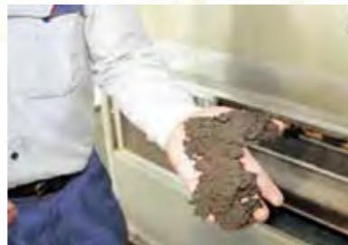
③ 下水処理場で処理されて出たドロ(下水汚泥)はレンガタイルなどに再利用されます。
