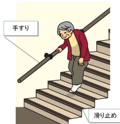
階段からの転落を防ぐ対策
