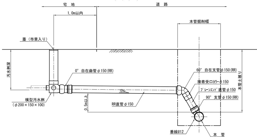
ドロップ污水樹取付管標準図 (Aタイプ)
