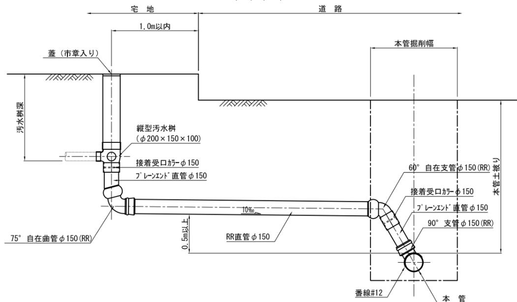
取付管標準土工断面図 縮尺 1:20
