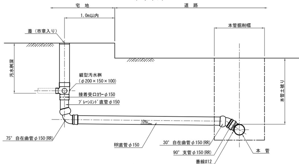
ドロップ污水樹取付管標準図 (Bタイプ)
