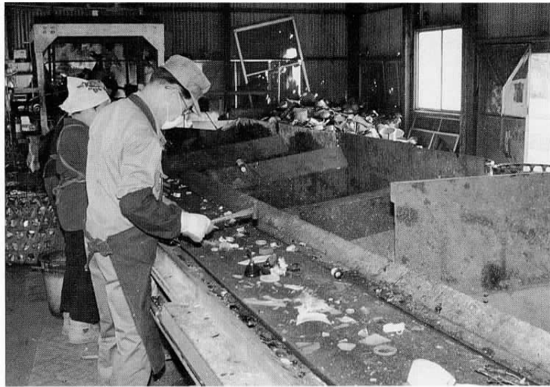
▲ビン、缶などの燃えないゴミを手作業で分別する現在のごみ処理場 (石岡・小川・玉里ごみ処理施設)。
