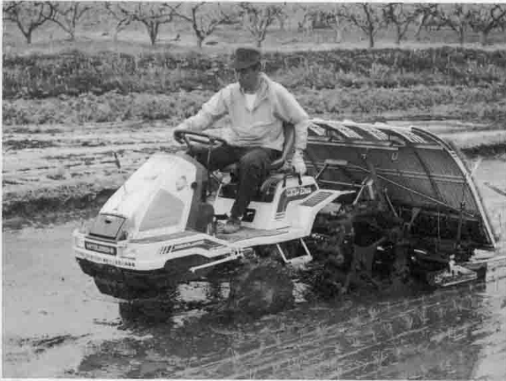
町の水田から流れ落ちる水は、恋瀬川や園部川を通して霞ヶ浦に注いでいます。町では浄化効果の高い施肥田植機を使っての田植えを進めています。写真は施肥田植機。
