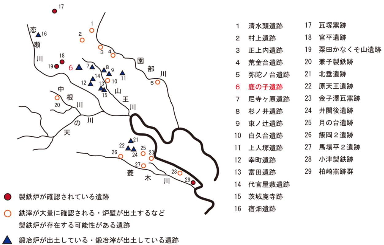
図3 常陸国府周辺の鉄生産の様子（小杉山 2009 をもとに作成）：製鉄炉は炉内にできた鉄を取り出すため毎回破壊するため、鉄滓（てっさい）のほかに大量の炉壁が出土します。一方、鍛冶炉は半球状に穴を掘削するだけの簡単な構造で、底にはお椀の底のような形をした鉄滓が溜まります。こうしてできた鉄滓を「椀形滓（わんがたさい）」といいます。したがって、発掘調査を行わなくても、鉄滓の様相でそこに製鉄炉があったのか鍛冶炉があったのかが推定できるのです。石岡市の場合、国府周辺では鍛冶炉・椀形滓が確認されることが多く、比較的離れたところで炉壁や製鉄炉が確認される傾向にあります。
