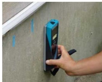
「基礎配筋」の調査機器
