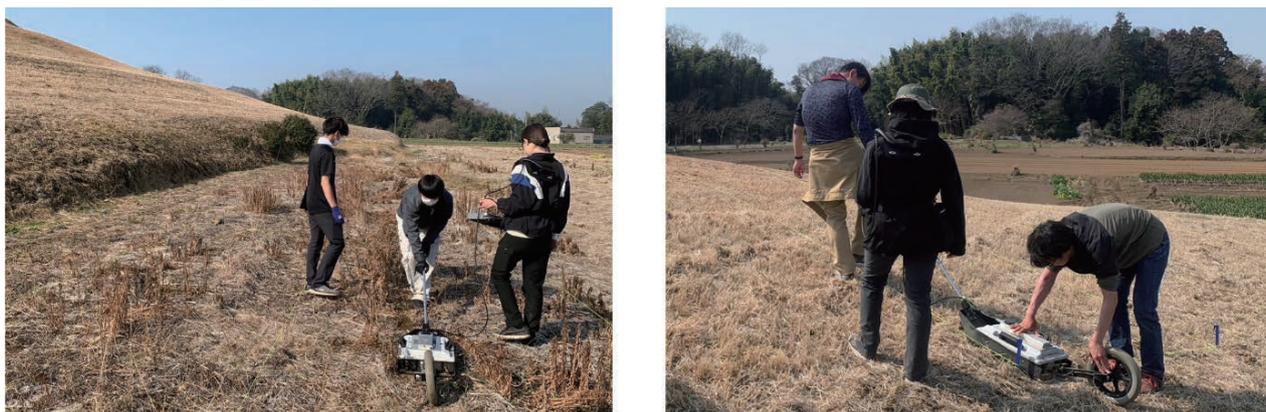
図4 地中レーダー探査の作業風景
