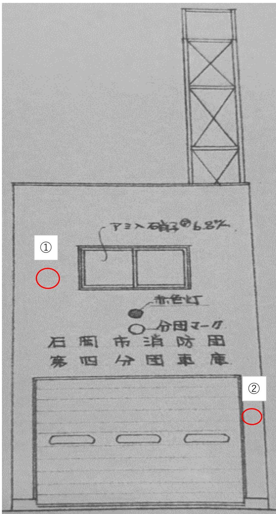
外壁ALC部 建物北側 補修材充填箇所図
